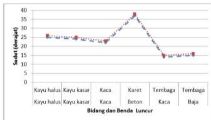
Gambar 14 Grafik Perbandingan Sudut Kemiringan Sistem dengan Alat Standar
