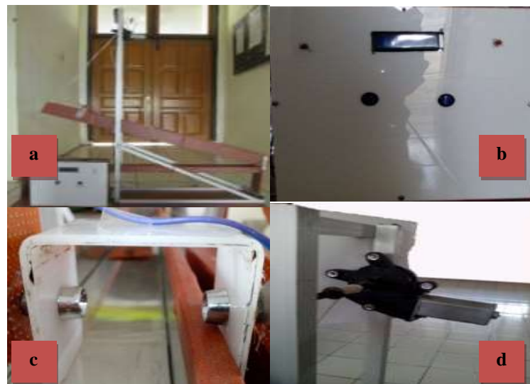
Gambar 10 Foto Hasil Rancangan Sistem: a) Set Eksperimen, b) Panel Depan, c) Sensor Phototransistor dan LED, d) Motor DC
