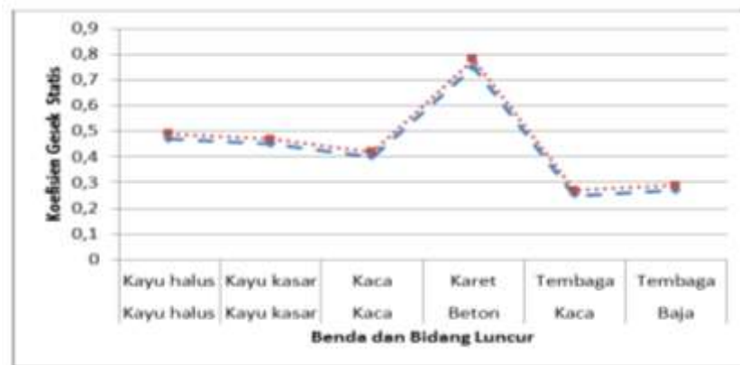
Gambar 15 Grafik Perbandingan Koefisien Gesek Statis Sistem dengan Alat Standar
